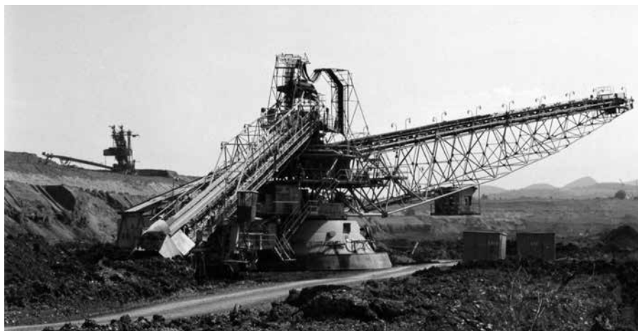
Zakládací velkostroj-zakladač. V pozadí na horizontu kolesové rýpadlo těžící první skryvkový řez (foto K. Walter)
